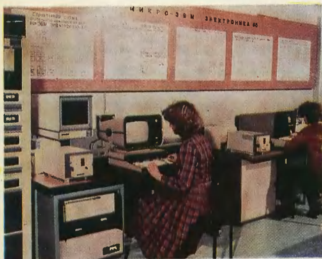
Система автоматического управления процессом ферментации «Автоферм» на основе микроЭВМ «Электроника 60» (фото слева) и блоки управления к этой системе на базе микропроцессорного комплекта КР580 (фото справа) (к ст. Г. А. Угодчикова, Н. А. Блинова, Г. А. Швецова).
